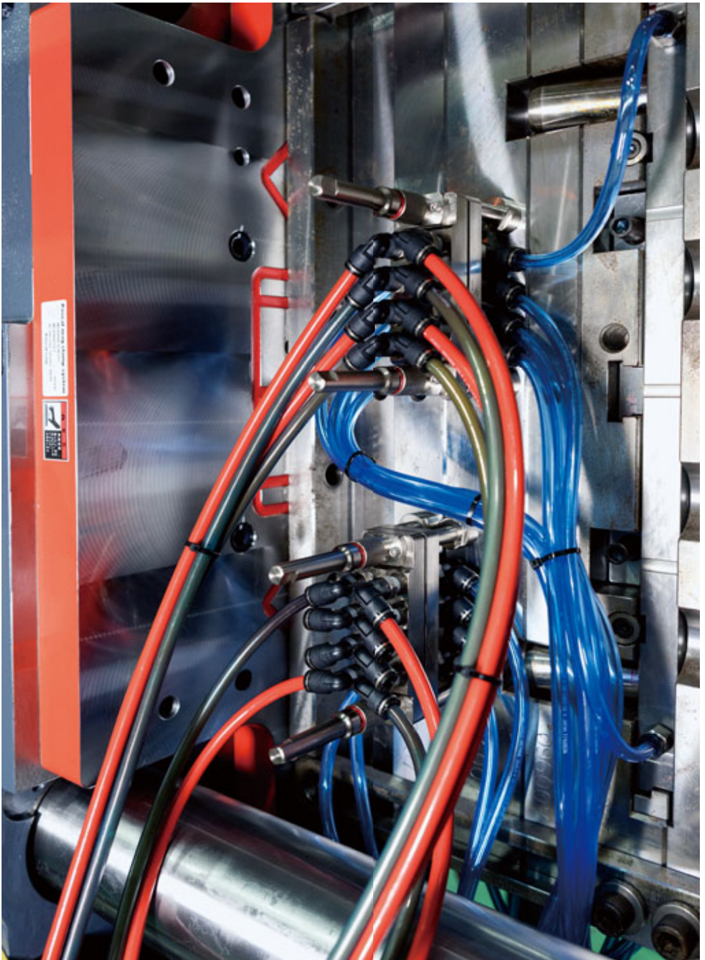
2,800kN (280ton) 成形機 立入れ マグクランプ & マルチカプラ オープンモデル
