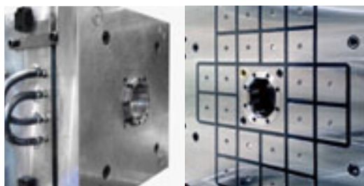
1,800kN(180ton) 成形機 立入れ オクタゴナルロケットリング&マグクランプ
