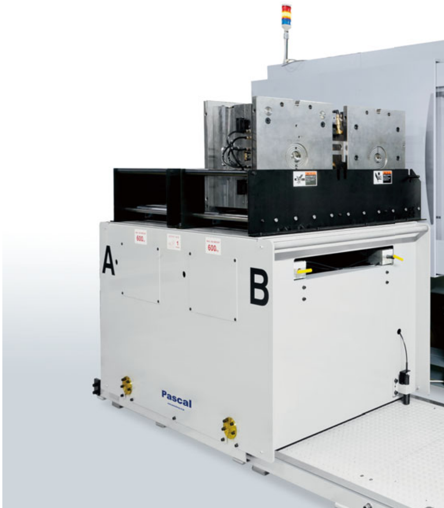
2,500kN (250ton) 2色成形機 横入れ マグクランプ & モールドダイチェンジャ
