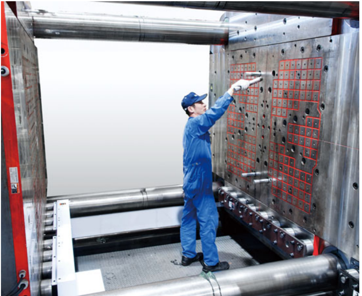
18,000kN (1,800ton) 成形機 横入れ マグクランプ & マグエジェクタロッド
