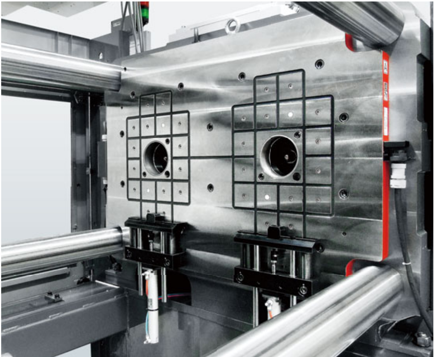
2,300kN (230ton) 2色成形機 立入れ マグクランプ & ダイセッタ
