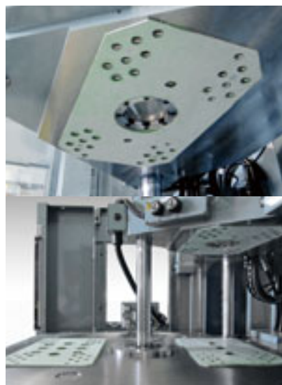
500kN(50ton) 縦型成形機 オクタゴナルロケットリング(上型位置決め) & フリーペア
