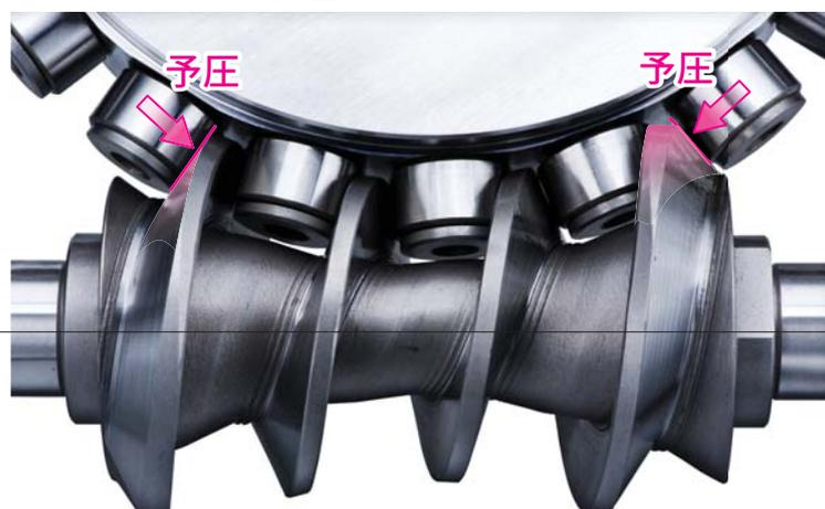
予圧がかかっていることにより、サーボモータのロックトルクを常時伝達することができ、ターレット軸にブレーキ力(クランプ力)が作動しています。そのため、外部ブレーキが不要です。
