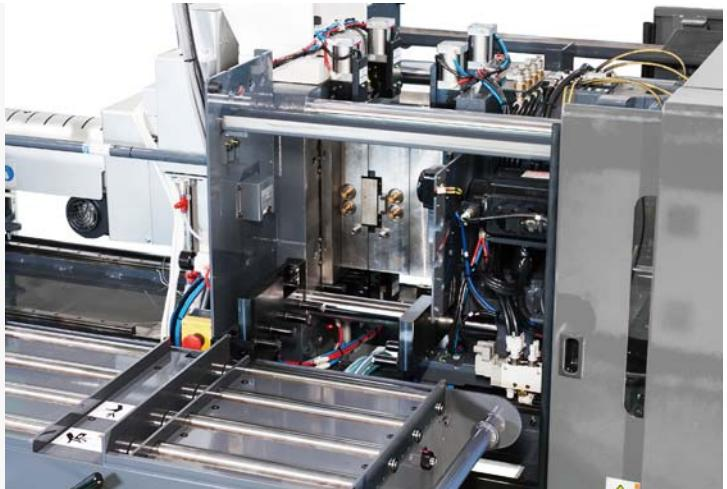
■ よこ入れ金型交換システム マグクランプ & モールドダイチェンジャ QME
