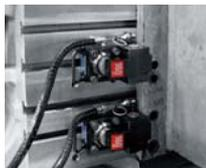
Mold die clamping system
