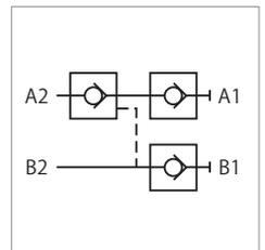
可简单连接双动夹紧器，并在切断油压源后也能长时间保持夹紧回路压力的无泄漏阀。
