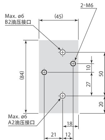
由于采用座垫式配管，因此安装面的最大表面粗糙度应加工在Rz6.3以下。
