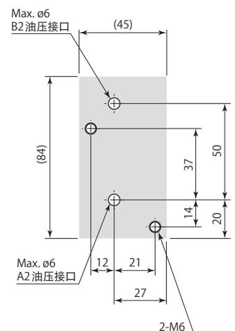
由于采用座垫式配管，因此安装面的最大表面粗糙度应加工在Rz6.3以下。
