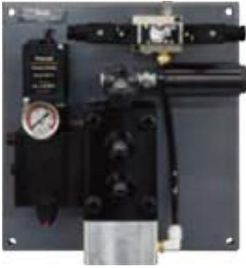
由机器方面提供油压源时，选定TKB型油压夹紧器
