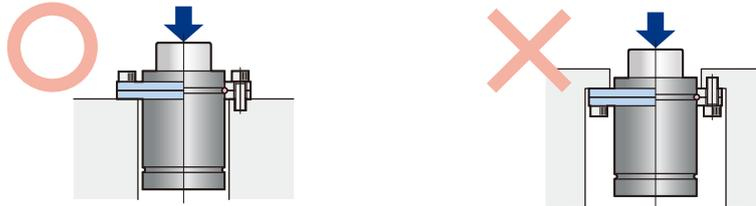
不应采用使安装螺栓承受拉伸载荷的安装方式。
