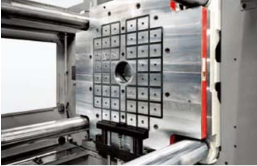
3,500kN (350ton) 注塑机 纵向搬入式 模具定位装置及电永磁夹紧器
