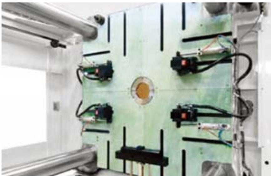
6,500kN (650ton) 注塑机 纵向搬入式 模具定位装置及自动滑行动式油压夹具 TYC100Z
