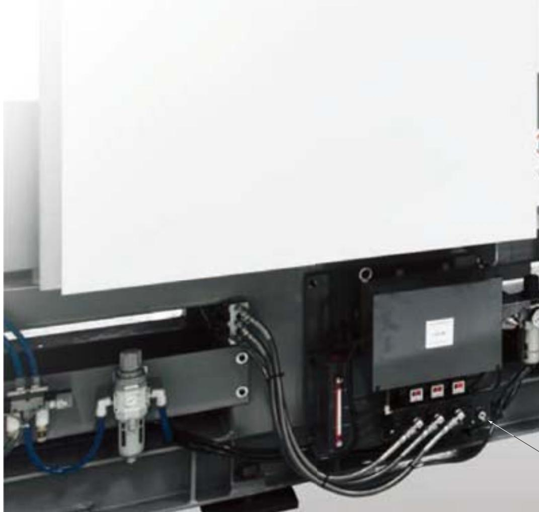
典型的导入实例:某大中型注塑机的换模时间为60分,导入模具夹紧系统后仅需30分,缩短一半。导入换模装置后又大幅度缩短到5分,如果每天换模5次,则生产线将缩短30%的时间,可大大减轻操作人员的作业负担。
