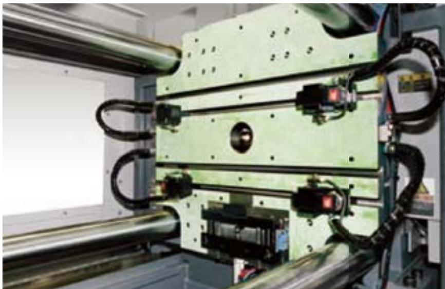
1,800kN (180ton) 注塑机 纵向搬入式 模具定位装置及滑行动式油压夹具 TYA040
