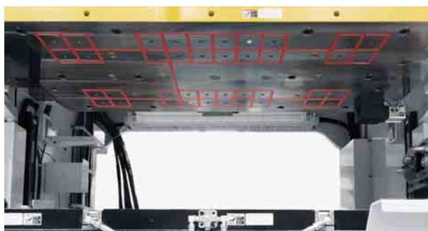
2,000kN (200 吨) 压力机 电永磁夹紧系统
