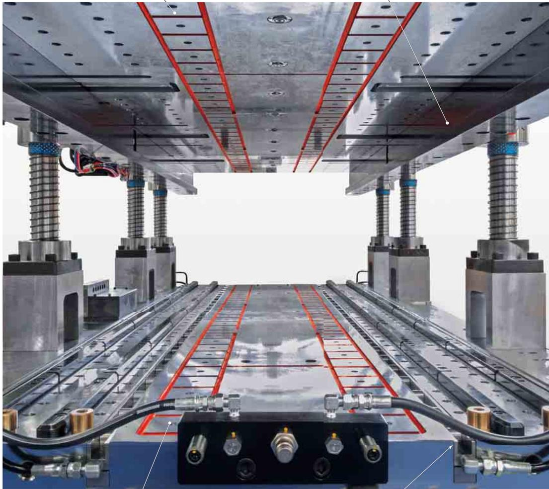
压力机电永磁夹紧系统(下模)
