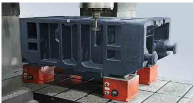
模具加工 双面电永磁夹紧器(两侧吸盘)
