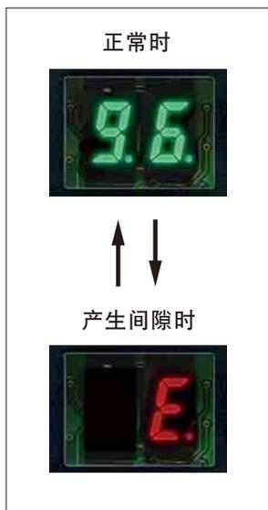
DD电永磁夹紧系统, 在控制箱上追加了状态显示面盘。
