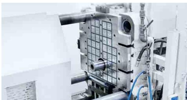
3,500kN (350 吨) 压铸机 电永磁夹紧系统
