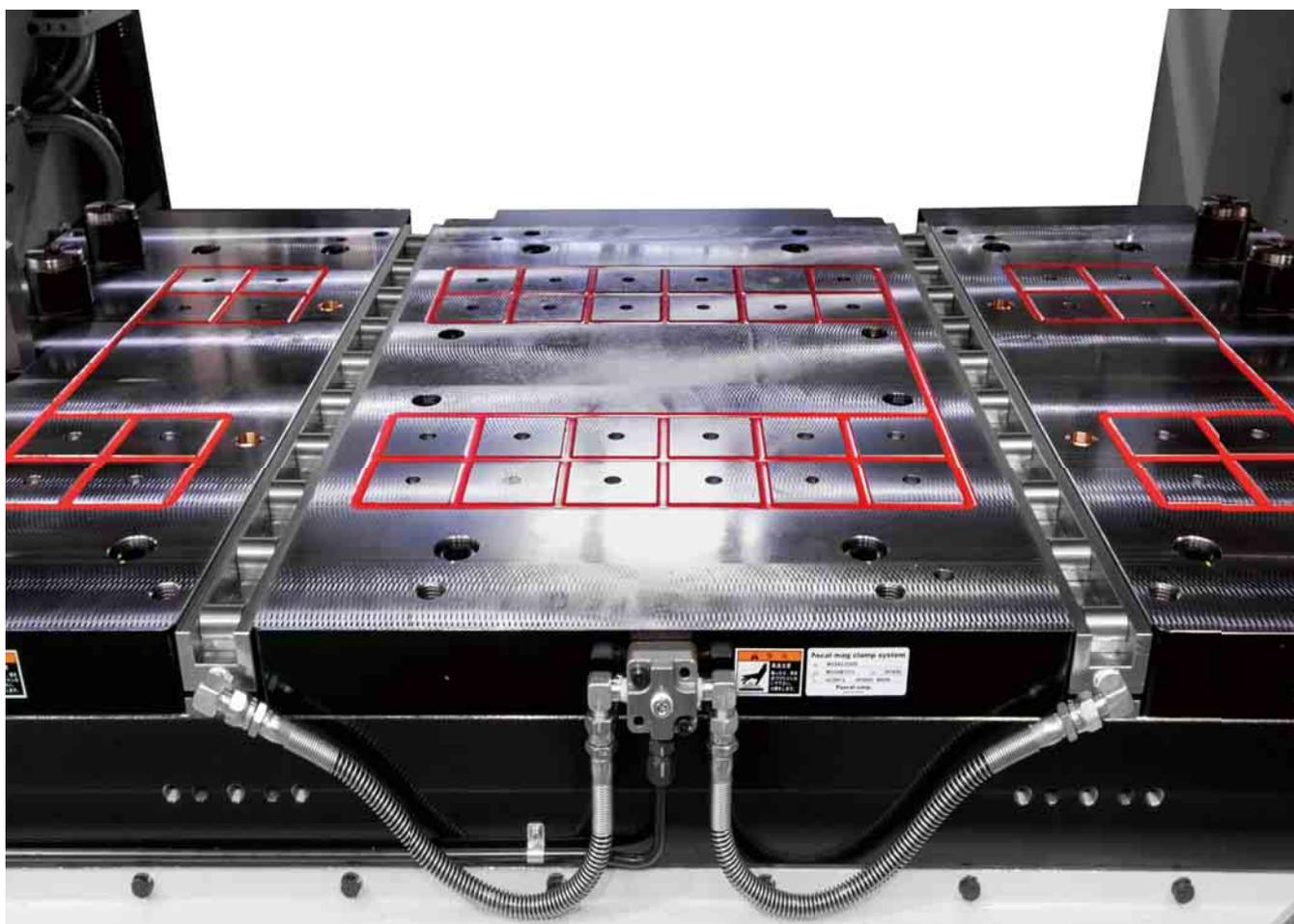
2,000kN (200tonf) 压力机 压力机电永磁夹紧系统
