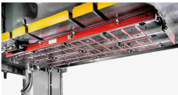
2,000kN (200 吨) 高速压力机 电永磁夹紧系统
