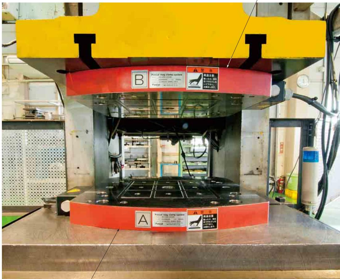
压力机电永磁夹紧系统(下模)
