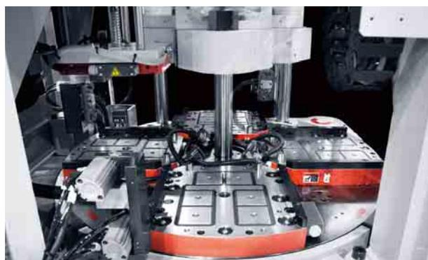
400kN (40 吨) 立式旋转注塑机 电永磁夹紧系统
