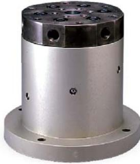
로터리조인트 model WRB는 저압용으로 개발된 로터리조인트입니다. 알루미늄보디를 채용하여, 경량화를 꾀하고 있습니다. 로터리샤프트의 관통홀을 이용하여 쿨런트 등을 배관할 수 있는 센터스루 타입입니다.
