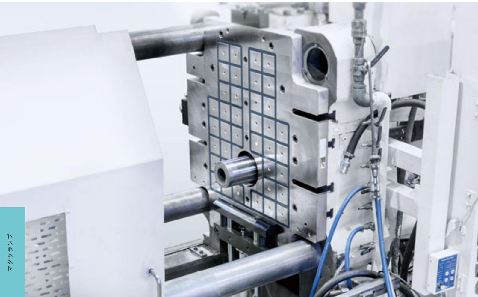
3,500kN (350ton) ダイカストマシン マグクランプ & ダイセッタ
