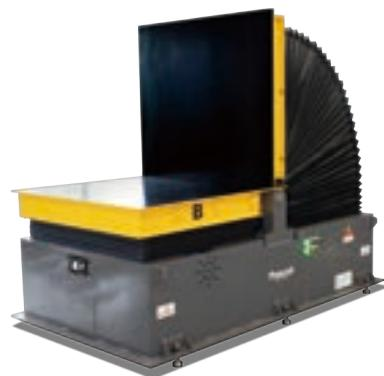
フラット型 90° 反転機 (油圧シリンダ駆動)
