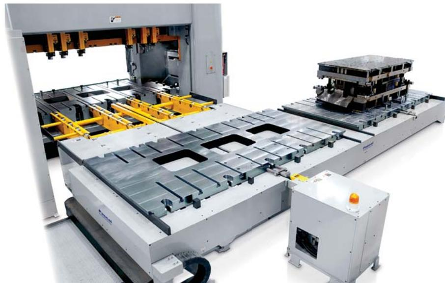
12,000kN プレス機械 金型交換装置
