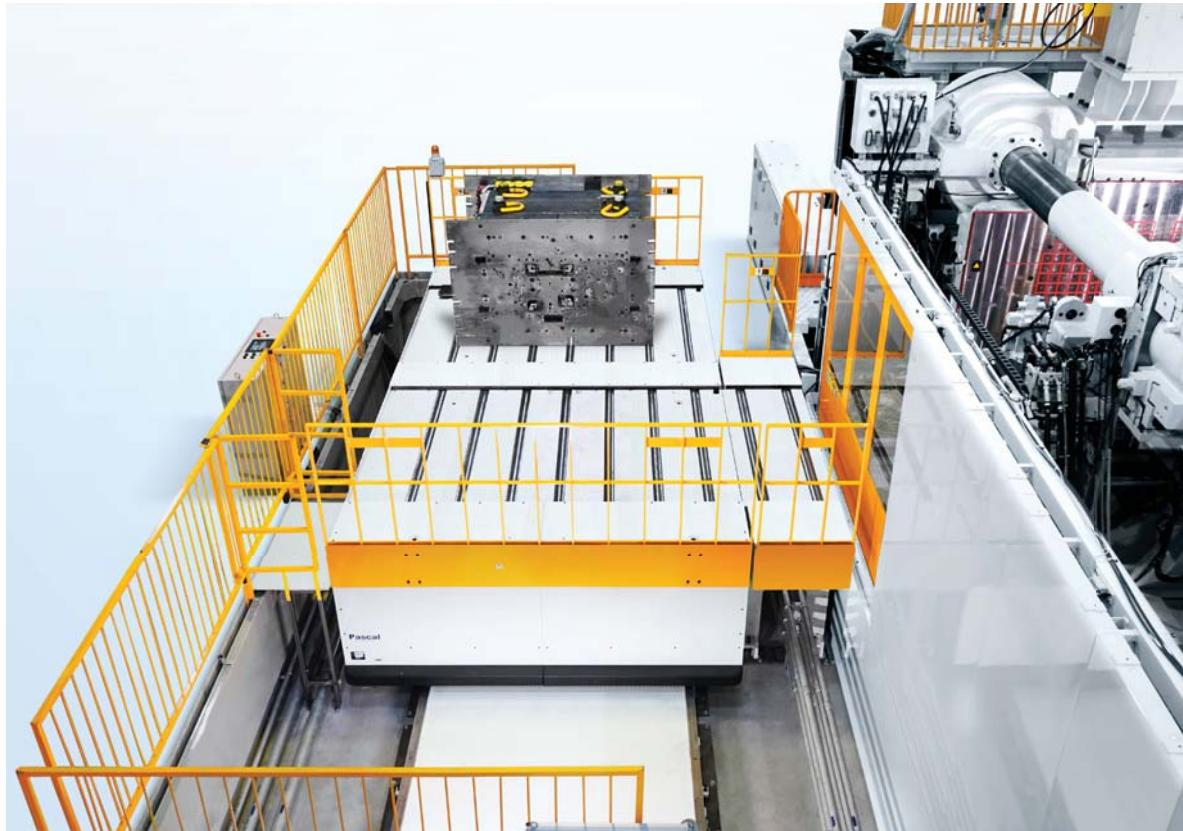
30,000kN 射出成形機 金型交換装置
