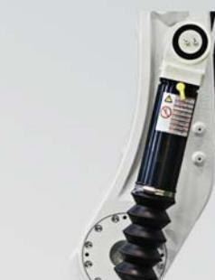
ロボット N<sub>2</sub>ガスバランサ
