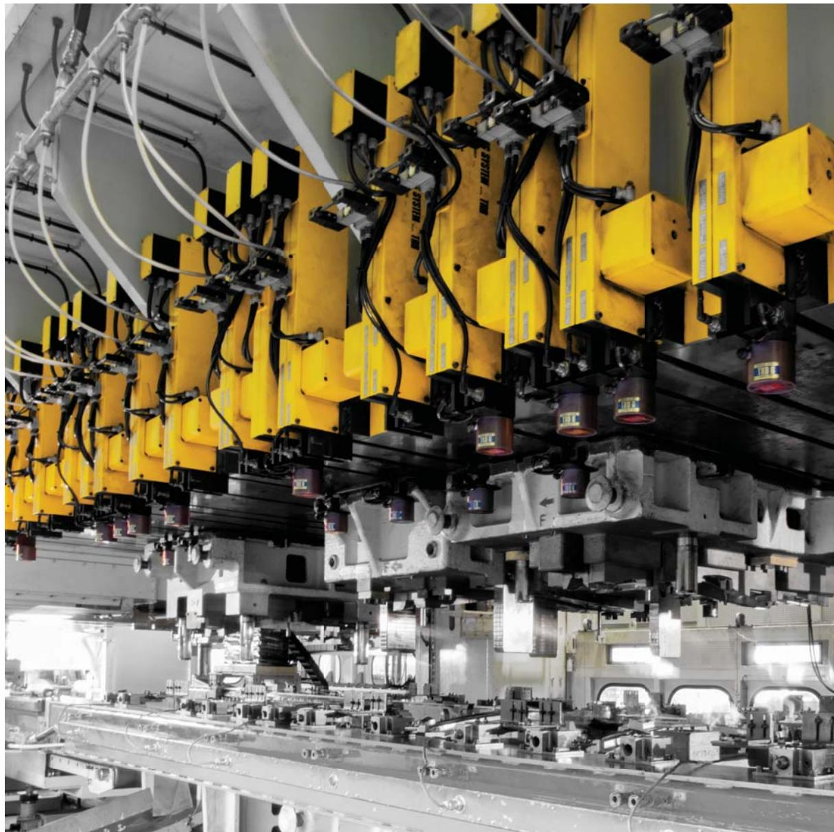
23,000kN トランスマーブレス トラベリングクランプ
