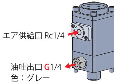
2010 年から製造している 1 ブロック型バルブ・シングルポンプのコントロールユニット
