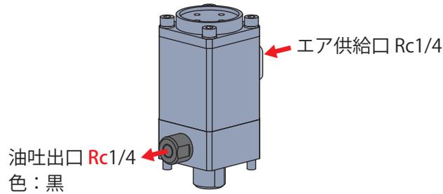
2003 ~ 2009 年に製造していたスタック型バルブ・ツインポンプの旧型コントロールユニット
