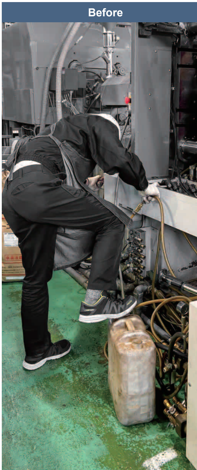
エアーカップラとホースを接続 水抜き & ポリタンク排水
