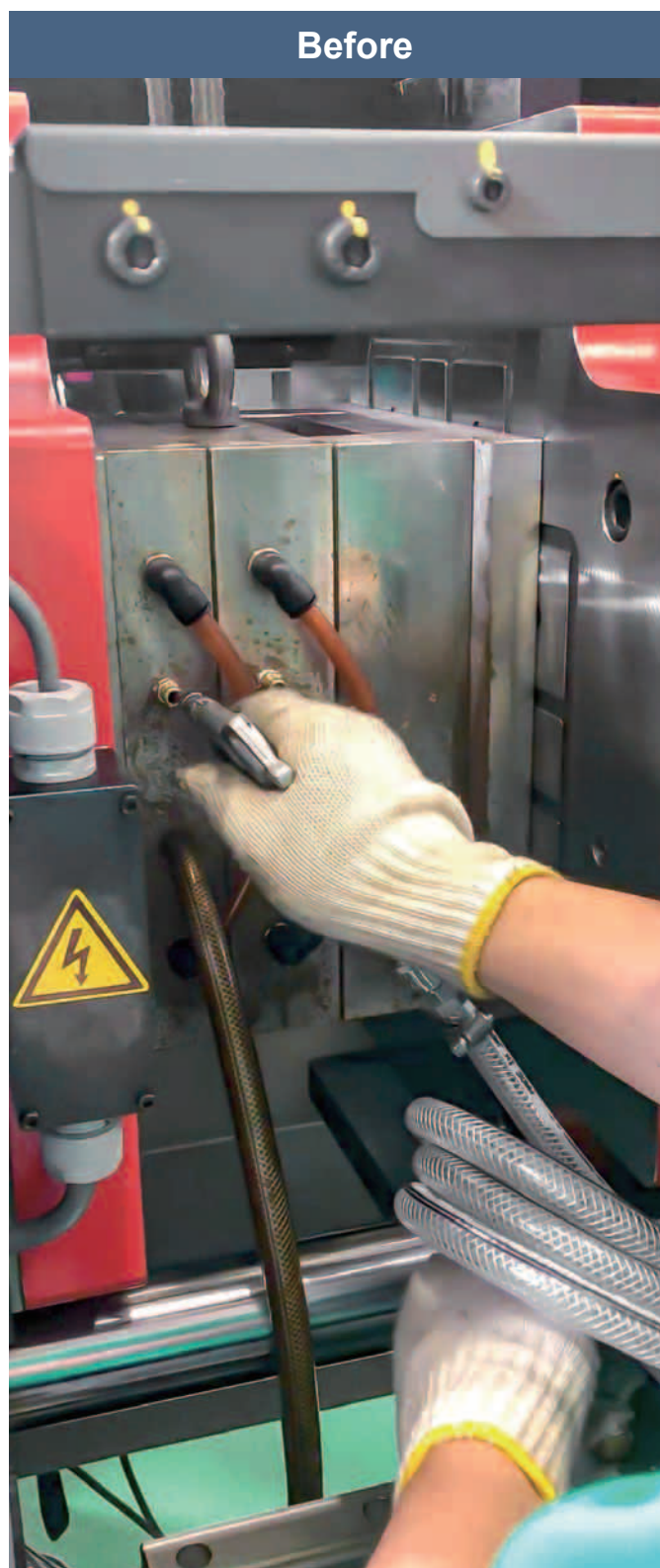
エアーガンで直接金型より水抜き
