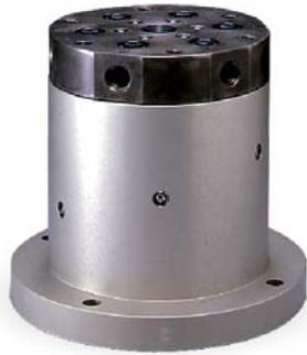
ロータリジョイントmodel WRBは低圧用に開発されたロータリジョイントです。アルミボディを採用し、軽量化を図っています。ロータリシャフトの貫通穴を利用して切削油などを配管することができるセンタスルータイプです。
