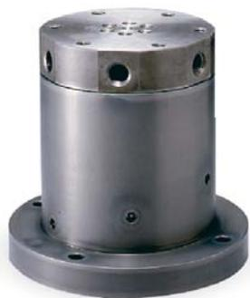
シングルロータリフランジは本体取付部をフランジ形状にし、全高を低く抑えたコンパクトタイプです。2回路から8回路までの4タイプから選定でき、各回路は独立して使用可能です。
