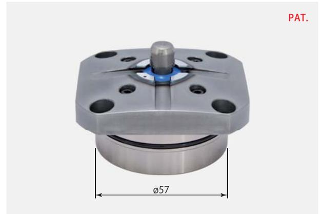
卡住内径为ø9、ø10的CGX-N22E型，在夹紧时，主杆一边扩张防尘密封一边移动，是一种主杆、爪卡及防尘密封之间无空间的新结构，所以可以防止切屑混入，加工中无需进行气压排尘。（仅在夹紧及放松动作时需要进行气压排尘。）比旧形式的空气消耗大幅减少。
