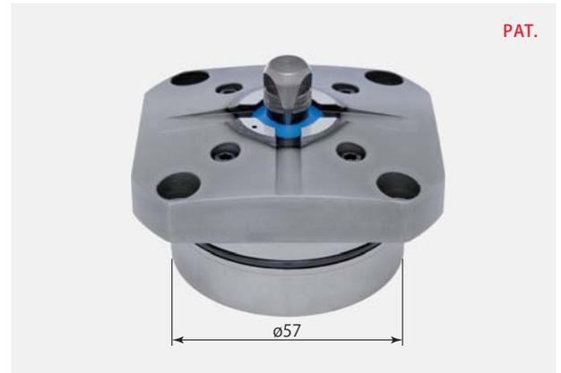
卡住内径为ø11~ø13的CGX-N22E型, 在夹紧时, 主杆一边扩张防尘密封一边移动, 是一种主杆、爪卡及防尘密封之间无空间的新结构, 所以可以防止切屑混入, 加工中无需进行气压排尘。(仅在夹紧及放松动作时需要进行气压排尘。)比旧形式的空气消耗大幅减少。
