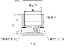
※:与工件支撑器本体一起包装的O形圈,请在使用配管块时安装。
