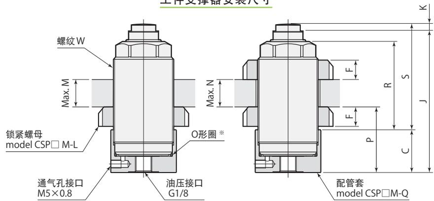
※: 与工件支撑器本体一起包装的O形圈, 请在使用配管套时安装。
