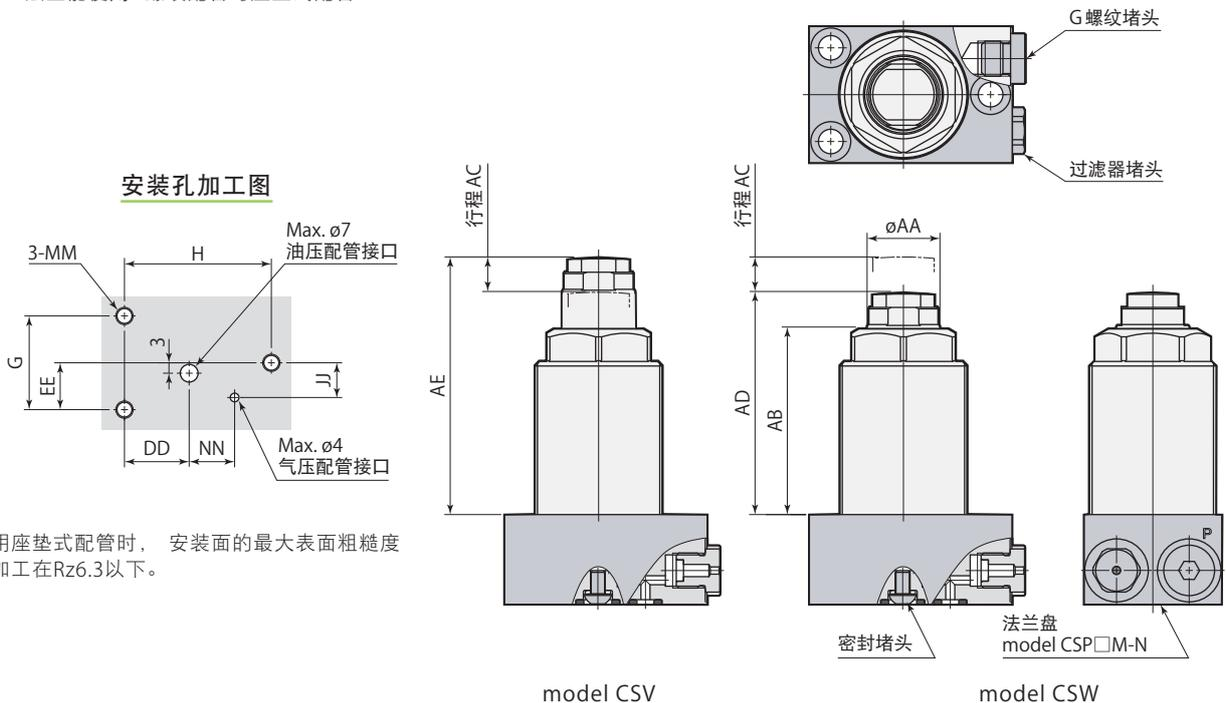
使用座垫式配管时, 安装面的最大表面粗糙度应加工在Rz6.3以下。
