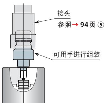
将氮气排放工具拧入气缸底面的充填口，
