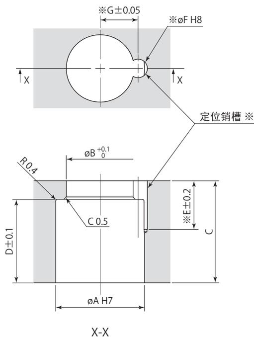
※:不使用定位销时, 定位销槽 (E、øF、G) 就无须加工。
