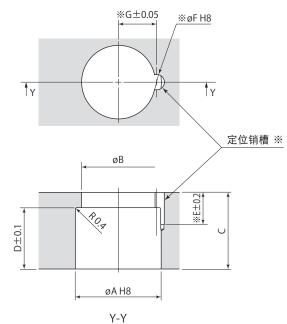
※:不使用定位销时,定位销槽 (E、øF、G)就无须加工。 (定位销能确切简单地定位夹 紧臂安装方向。)
